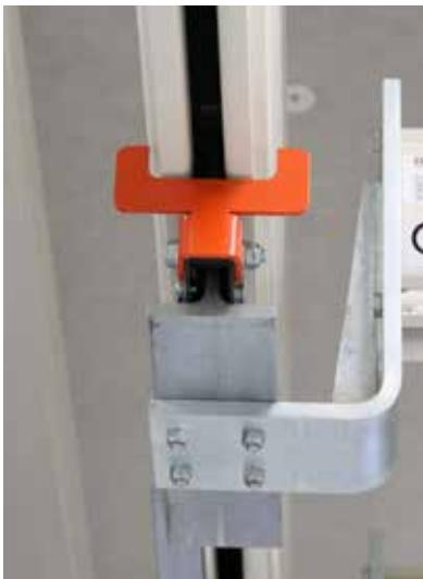
På lastsystem från 1000 kg är det standard med överlastindikator.
