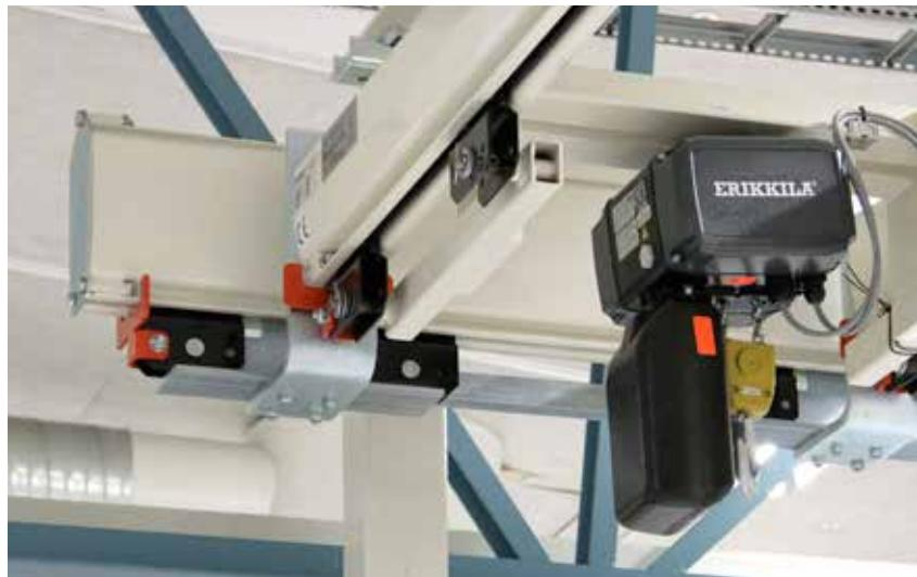
Här visar vi den mest kompakta standardlösningen. Ett lastsystem med upphöjd dubbelbalk och med en förhöjd brygga för telfer. Detta ger maximal lyft höjd och minsta bygghöjd.
