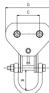
BALKKLÄMMA / BEAM CLAMP - Model A
