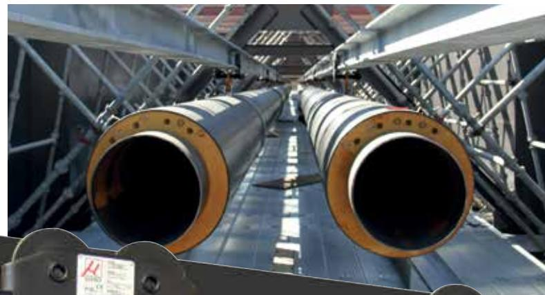
System för rörupphängning. En optimal lösning för installation av fjärrvärme/kyla vid montage under broar, i tunnlar m.m. Dimensioner Ø 100 - 1000 mm.
