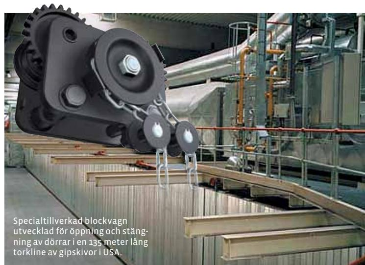
Specialtillverkad blockvagn utvecklad för öppning och stängning av dörrar i en 135 meter lång torkline av gipskivor i USA.
