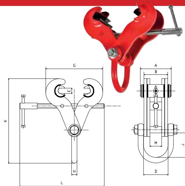
BALKKLÄMMA / BEAM CLAMP - Model S
