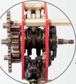
Lastbroms med dubbla spärrhakar håller lasten säkert.
