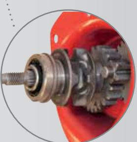
Kothjul och drivaxel är lagrade på 2 st hållager.
