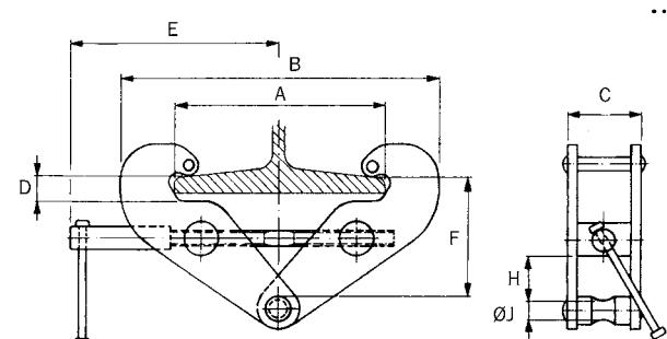
BALKKLÄMMA/BEAM CLAMP - 50
